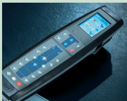
Пульт управления с программируемым сенсорным экраном
